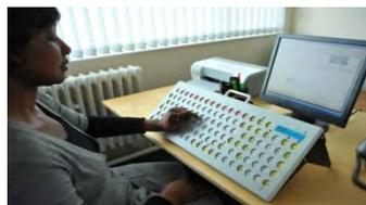
**Fig. 2:** Teclado gigante con protector de teclas para impedir la pulsación errónea.
